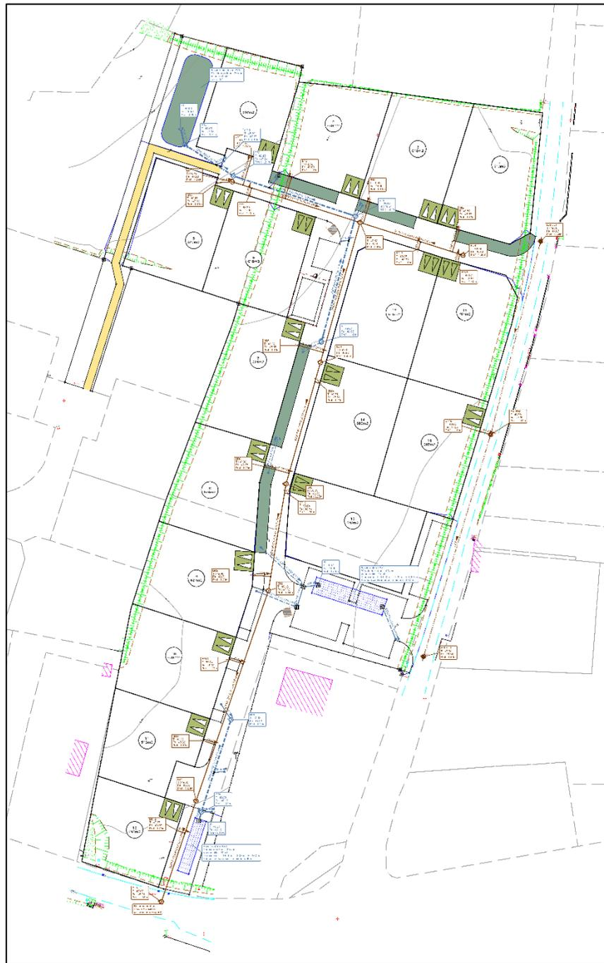
Figure n°1 : Plan du réseau des eaux pluviales et des eaux usées (Source : TECAM)
