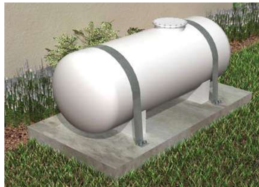
Renforcement du support et de l'ancrage de la cuve
