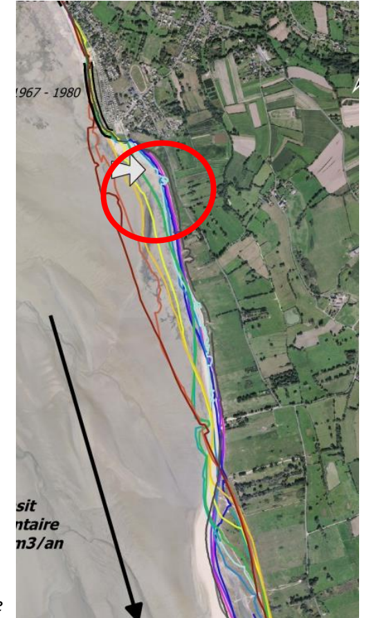
Risque de rupture du cordon dunaire
