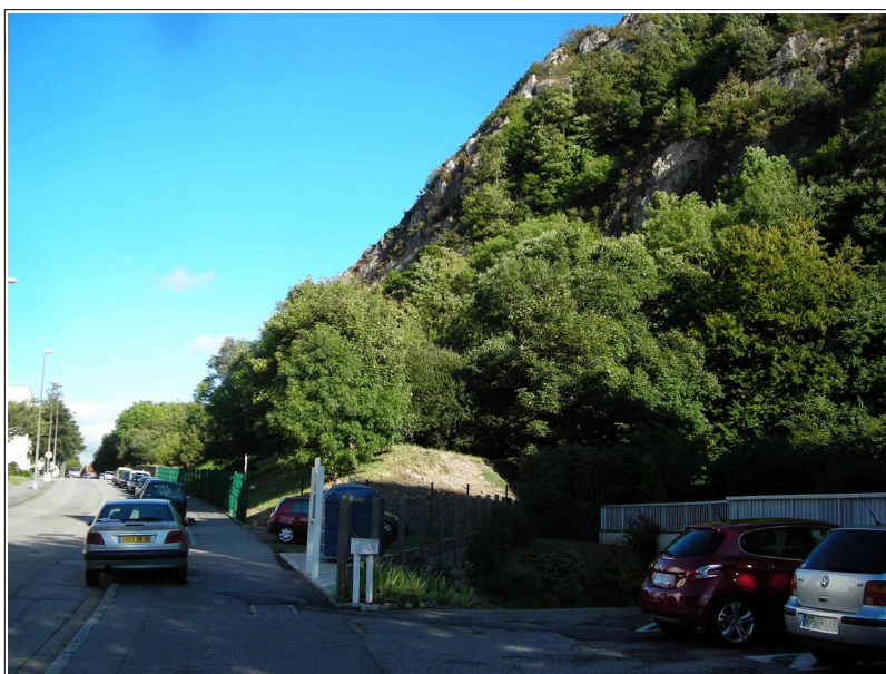
figure 104 : Rue Lecarpentier, le terrain est plat à l'aval de la falaise ce qui laisse présager des arrêts rapides des blocs en mouvement.
