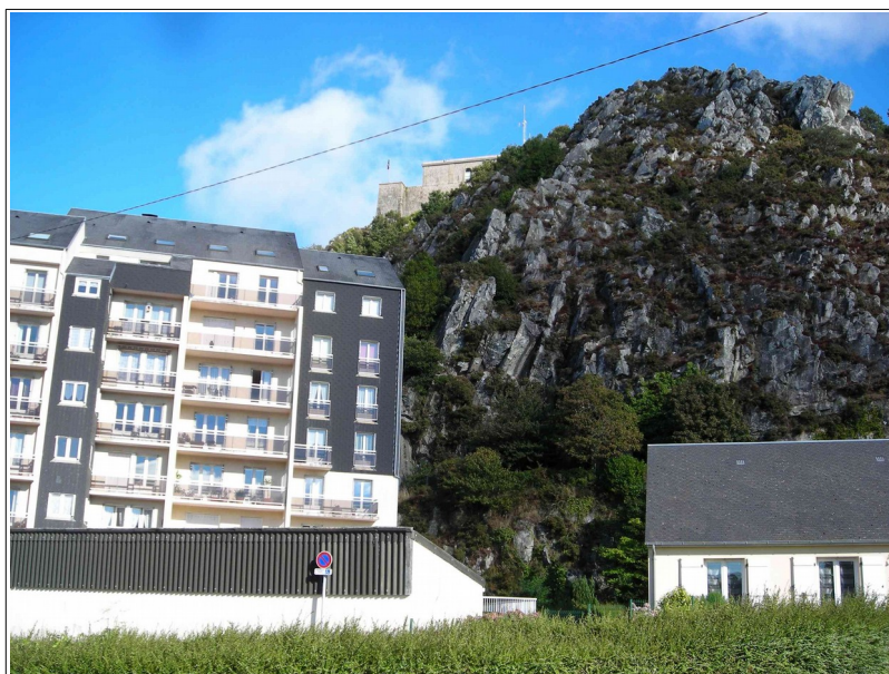
figure 105 : Vue depuis la montée des Résistants, la carte BRGM affiche un zonage atteignant, voire franchissant cette rue. La planéité du terrain atténue de telles propagations initiées par la taille des blocs, la hauteur de chute et les rebonds sur le flanc de falaise.
