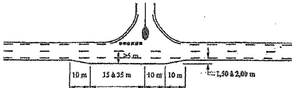
Il faut rechercher une largeur « roulable », entre l'axe de la chaussée et le bord extérieur de la sur largeur, de 5 m au moins ; cela correspond généralement à une sur largeur de 1,50 m à 2,00 m.
