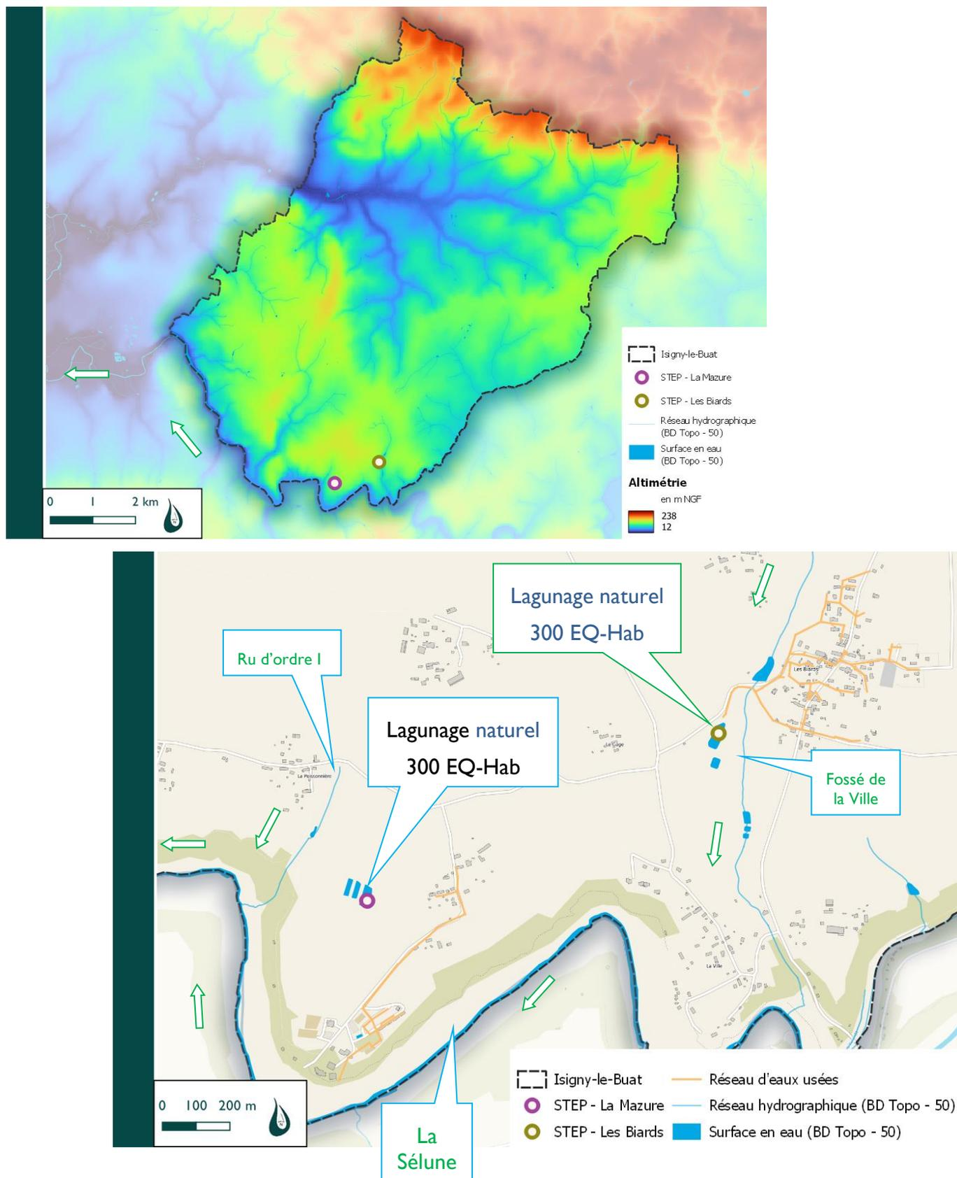
Figure 4 : Topographie de la Commune, sens d'écoulement des eaux et milieu récepteur des rejets des deux STEP – DMEAU 2023
