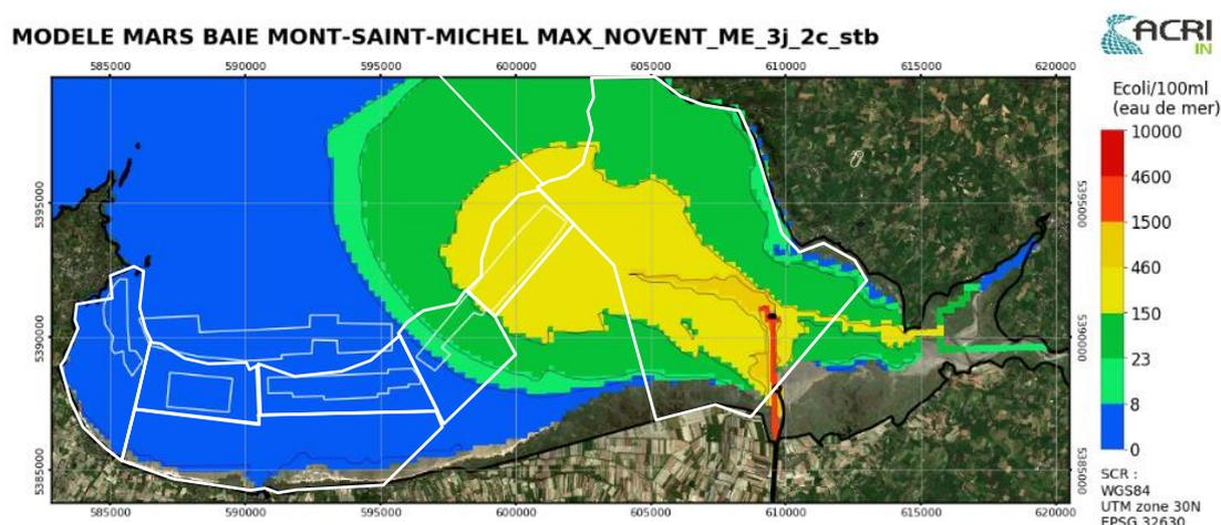
Figure 28 : Extension maximale du panache de contamination des trois cours d'eau (Sée, Sélune, Couesnon), lors d'une crue hivernale sous pluie, sans vent.
