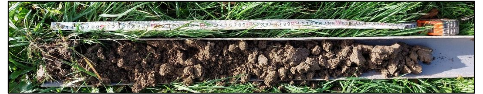
Figure n°38 : Photo du profil du sondage n°2 (Source : TECAM)
