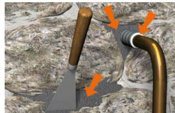
Situation après travaux : colmatage des voies d'eau.
