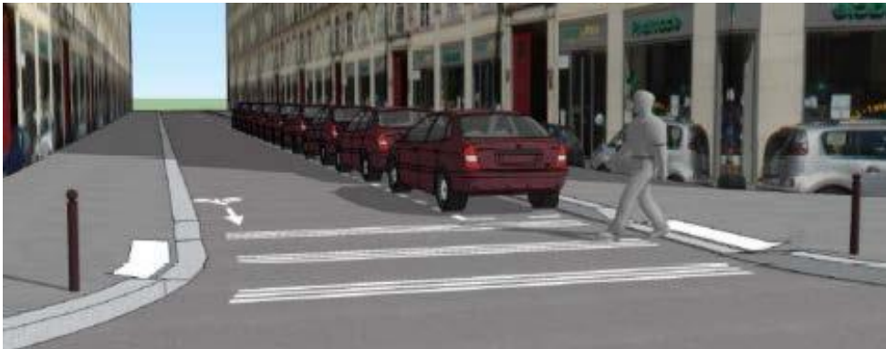
Principe de l'expérimentation de la ville de Paris : mini bandes 10 cm espacées de 10 cm sur 3 rangées (©F. Prochasson)
