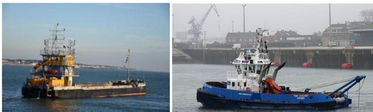
**Figure 3-5 - Barge automotrice et remorqueur équipé d'une drague niveleuse (Source : SGRE, 10/2021)**
