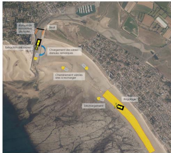
Figure 10 : Organisation de chantier lors de l'extraction des sédiments
