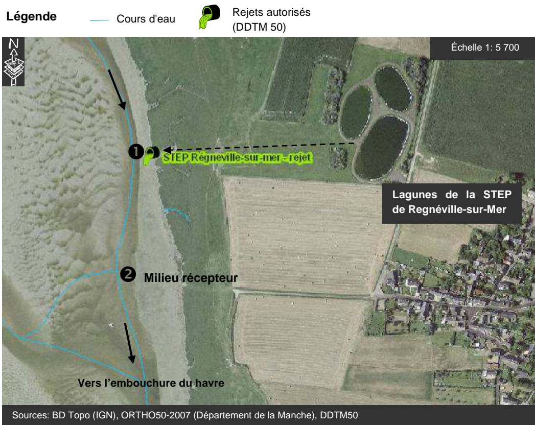
Figure 35 : Localisation des points de suivi du rejet de la station d'épuration de Regnéville-sur-Mer (DDTM50)
