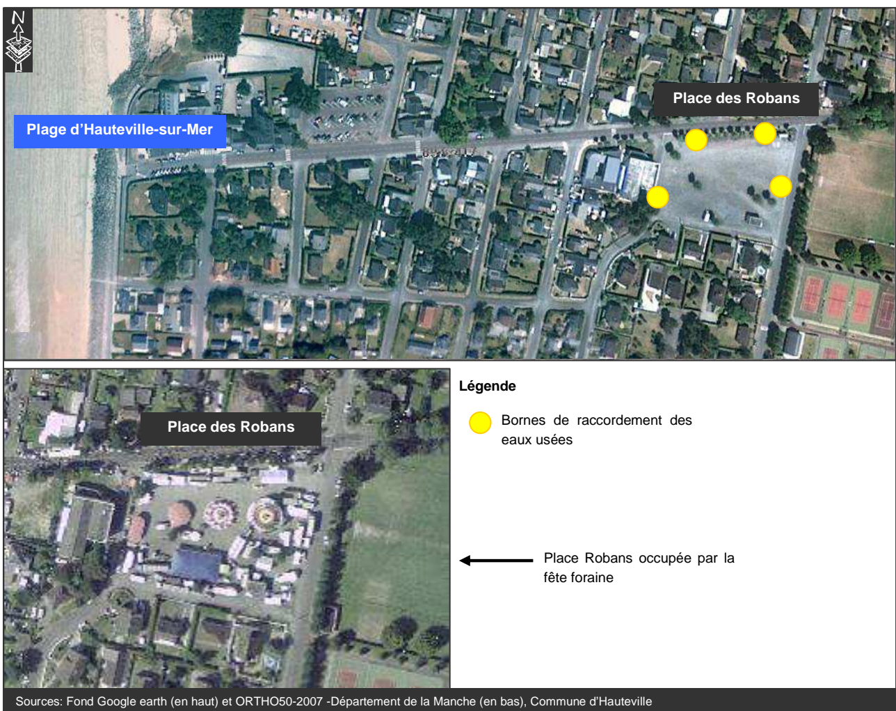
Figure 85 : Localisation des bornes de raccordement "Eaux usées" sur la place Robans à Hauteville-sur-Mer
