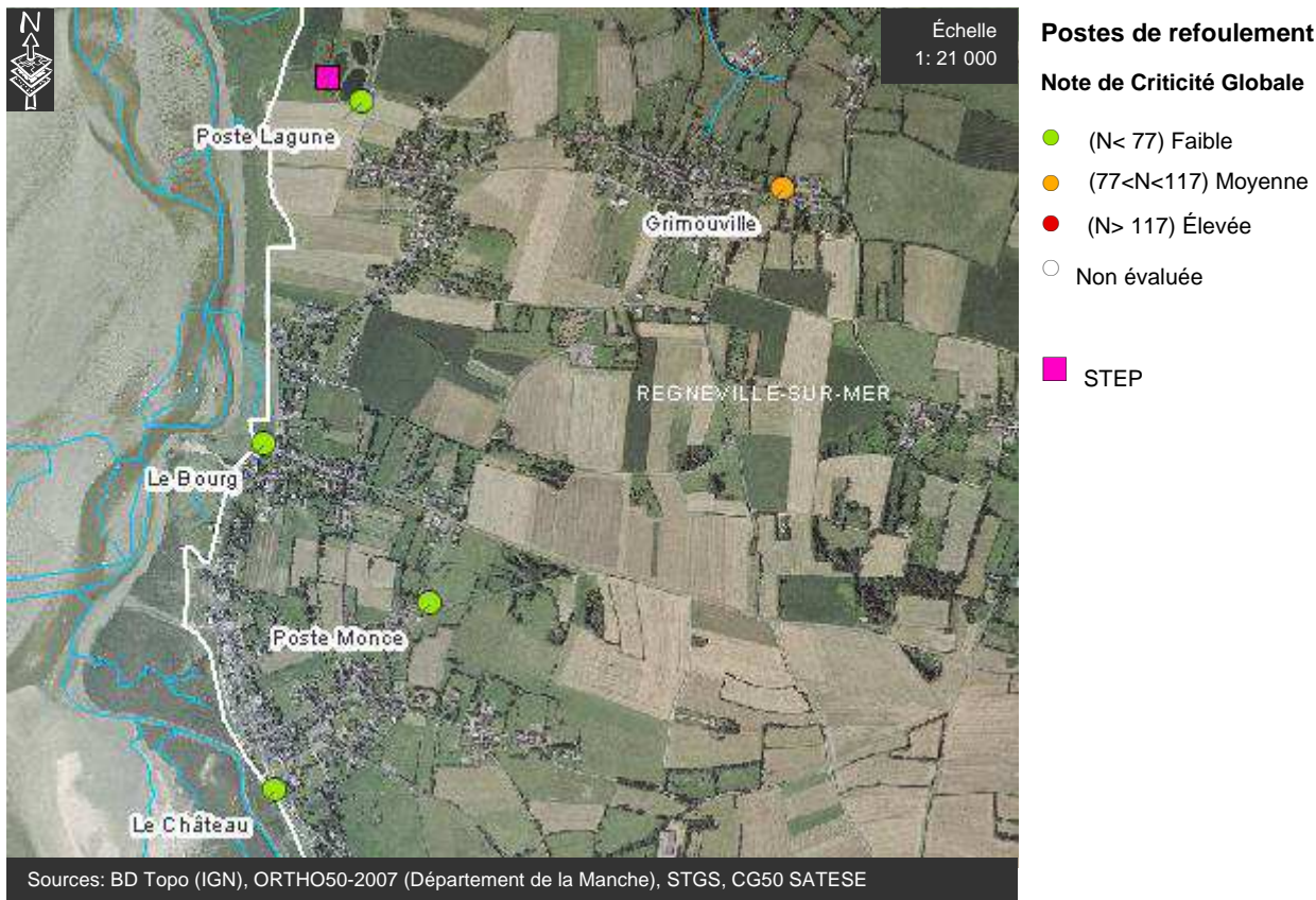
Figure 66 : Criticité globale des postes de refoulement sur le secteur de Regnéville-sur-Mer
