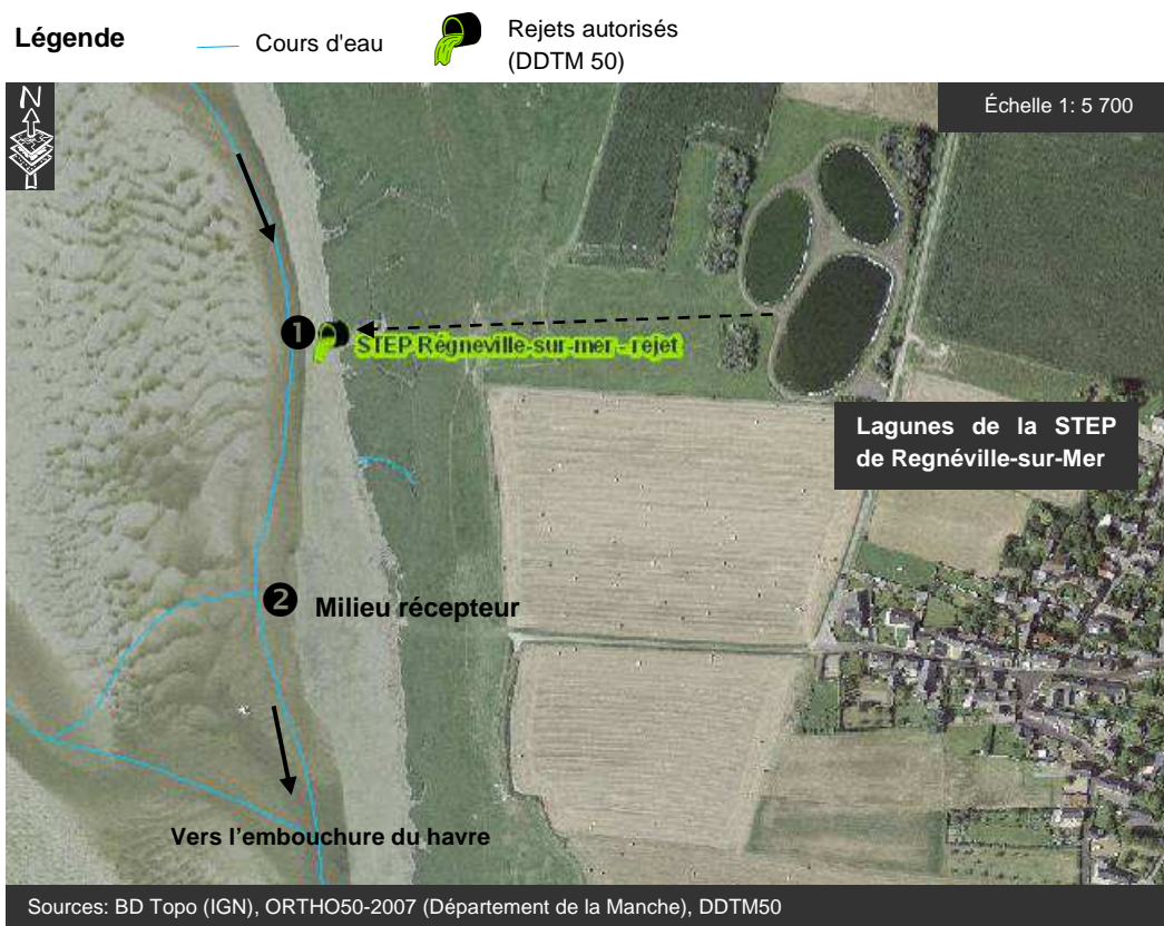
Figure 30 : Localisation des points de suivi du rejet de la station d'épuration de Regnéville-sur-Mer (DDTM50)
