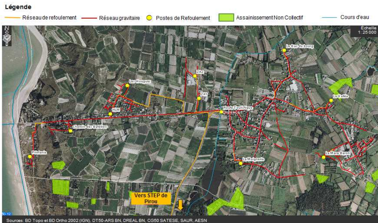
Figure 47 : Localisation des réseaux d'assainissement collectif et zones d'assainissement non collectif sur le secteur de Créances
